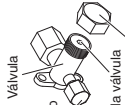
Fita Isolante Enrole a fita sem folgas para evitar a entrada de água de chuva ou água resultante de drenagem pelos bordos do isolante.
